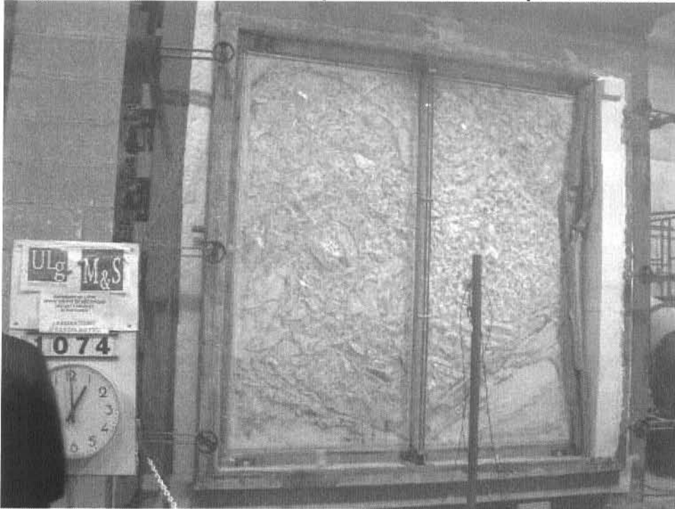
Figure 10 Vue de la face non exposée au feu au temps 75 minutes
