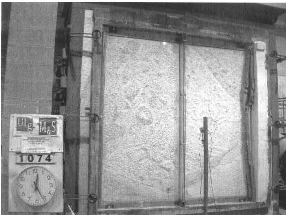
Figure 6 Vue de la face non exposée au feu au temps 26 minutes
