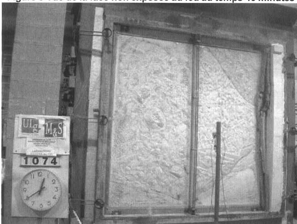
Figure 8 Vue de la face non exposée au feu au temps 40 minutes
