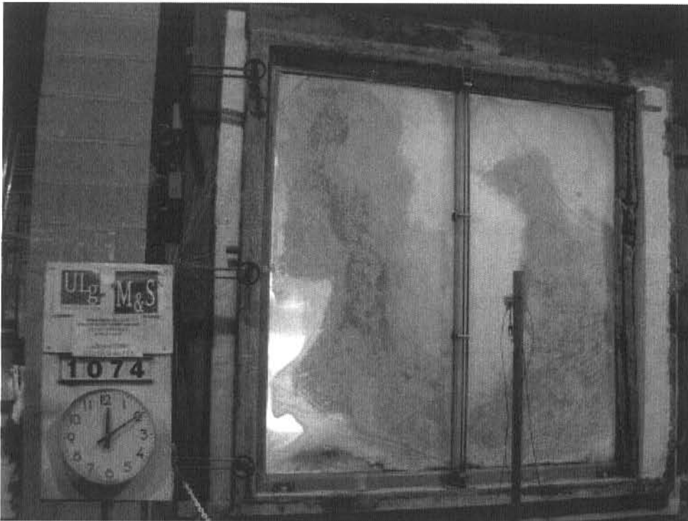
Figure 4 Vue de la face non exposée au feu au temps 17 minutes
