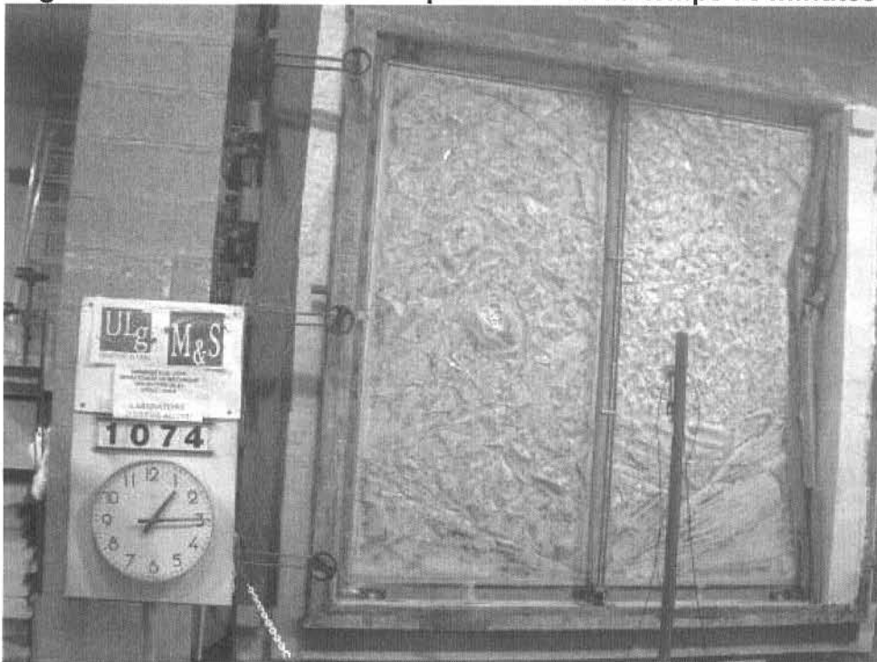
Figure 10 Vue de la face non exposée au feu au temps 75 minutes
