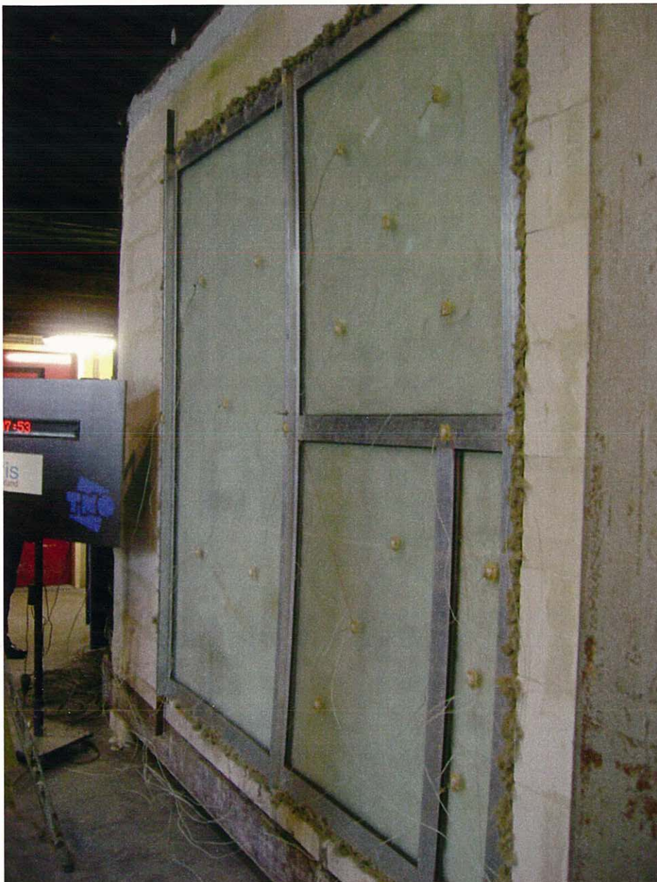
Foto 4 : aanzicht van de constructie na 8 minuten verhitting. Er is te zien dat het verstevigingprofiel de linkerwand op zijn plek houdt en weerstand biedt tegen doorbuiging. De rest van het frame buigt naar het vuur toe.
