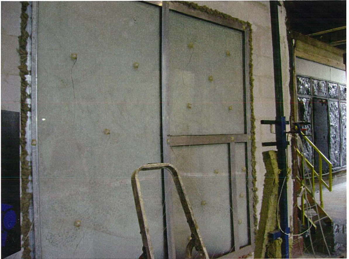
Foto 2 : aanzicht van de constructie na 2'55" minuten verhitting. Er is nu goed te zien dat alle ruiten zijn opgeschuimd.
