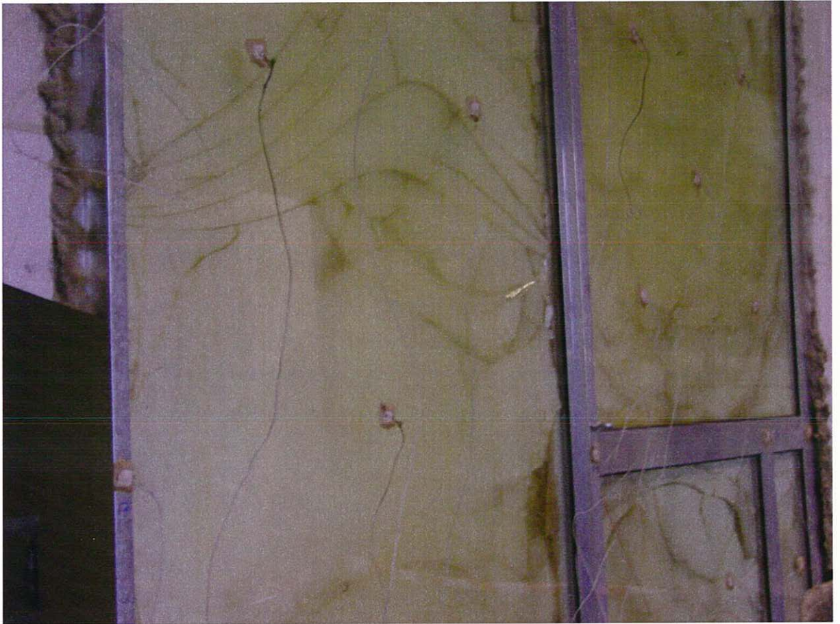
Foto 6 : aanzicht van de constructie na 29 minuten verhitting. Je ziet duidelijk dat de ruiten beginnen weg te vallen aan de binnenzijde. Buitenste laag glas houdt nog wel stand.
