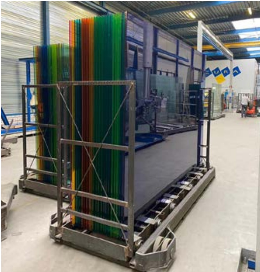
CURA Safe gelaagd glas met Blank Float en gekleurde Vanceva PVB-folie
