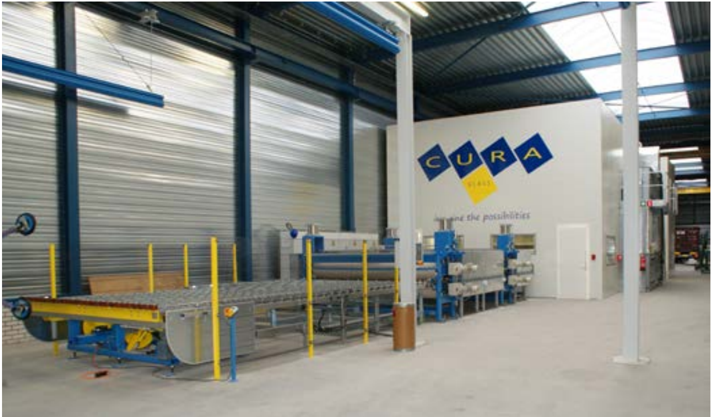
Onze Benteler-lamineerlijn voor de productie van CURA Safe met PVB-folie
